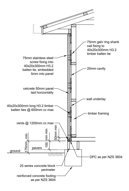
SINGLE STOREY SECTION - 20mm CAVITY CAD REF 3-2-20 SCALE 1:20
