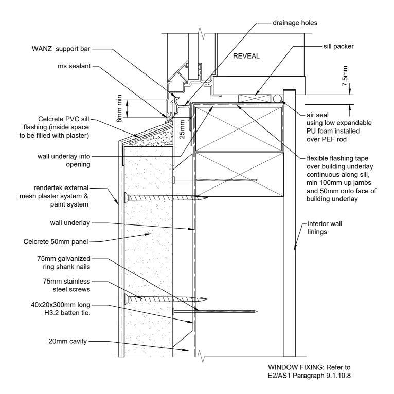
ALUMINIUM WINDOW SILL - 20mm CAVITY CAD REF 7-3-20 SCALE 1:2 Cel
