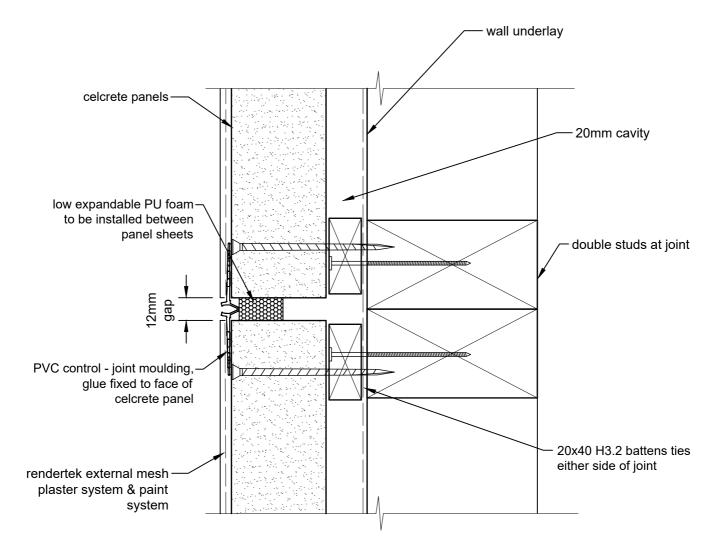
PLAN VIEW VERTICAL CONTROL JOINT DETAIL - MAXIMUM 8m CRS CAD REF 6-1-20 SCALE 1:2
