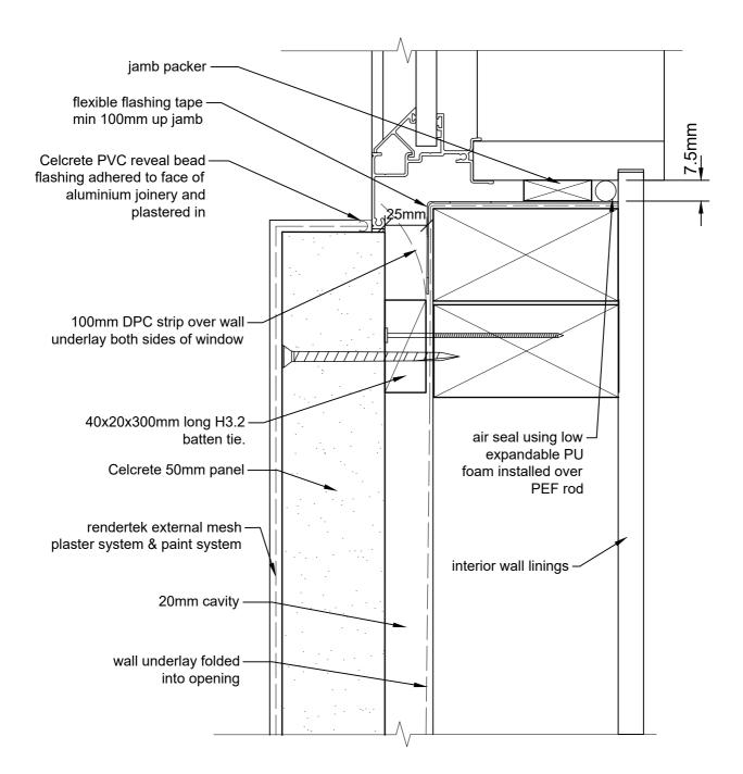
PLAN VIEW ALUMINIUM WINDOW JAMB - 20 CAVITY CAD REF 7-2- 20
